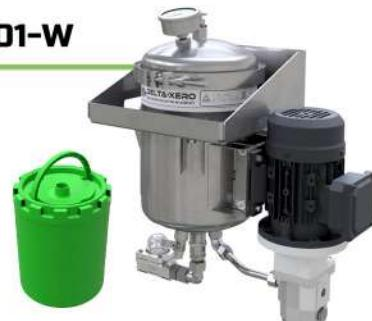
خانواده محصولات فیلتراسیون قابل نصب روی دیوار شامل سه گروه است: دستگاه‌های تک فیلتره (DX1001-W) تا حجم ۴۵۰ لیتر و دبی ۱/۲۵ لیتر بر دقیقه، دو فیلتره (W) (DX1002-W) تا حجم ۹۰۰۰ لیتر و دبی ۲/۵ لیتر بر دقیقه، و سه فیلتره (DX1003-W) تا حجم ۱۳۵۰۰ لیتر و دبی ۳/۷۵ لیتر بر دقیقه. این خانواده برای تصفیه انواع روغن‌های هیدرولیک، روانکاری و روغن سوخت و حذف انواع آلودگی‌ها تا رده ۰/۱ میکرون قابل استفاده است. این محصولات در نسخه‌های ضدانفجار (Ex)، با انواع موتورها و تجهیزات جانبی نیز عرضه می‌شود.
